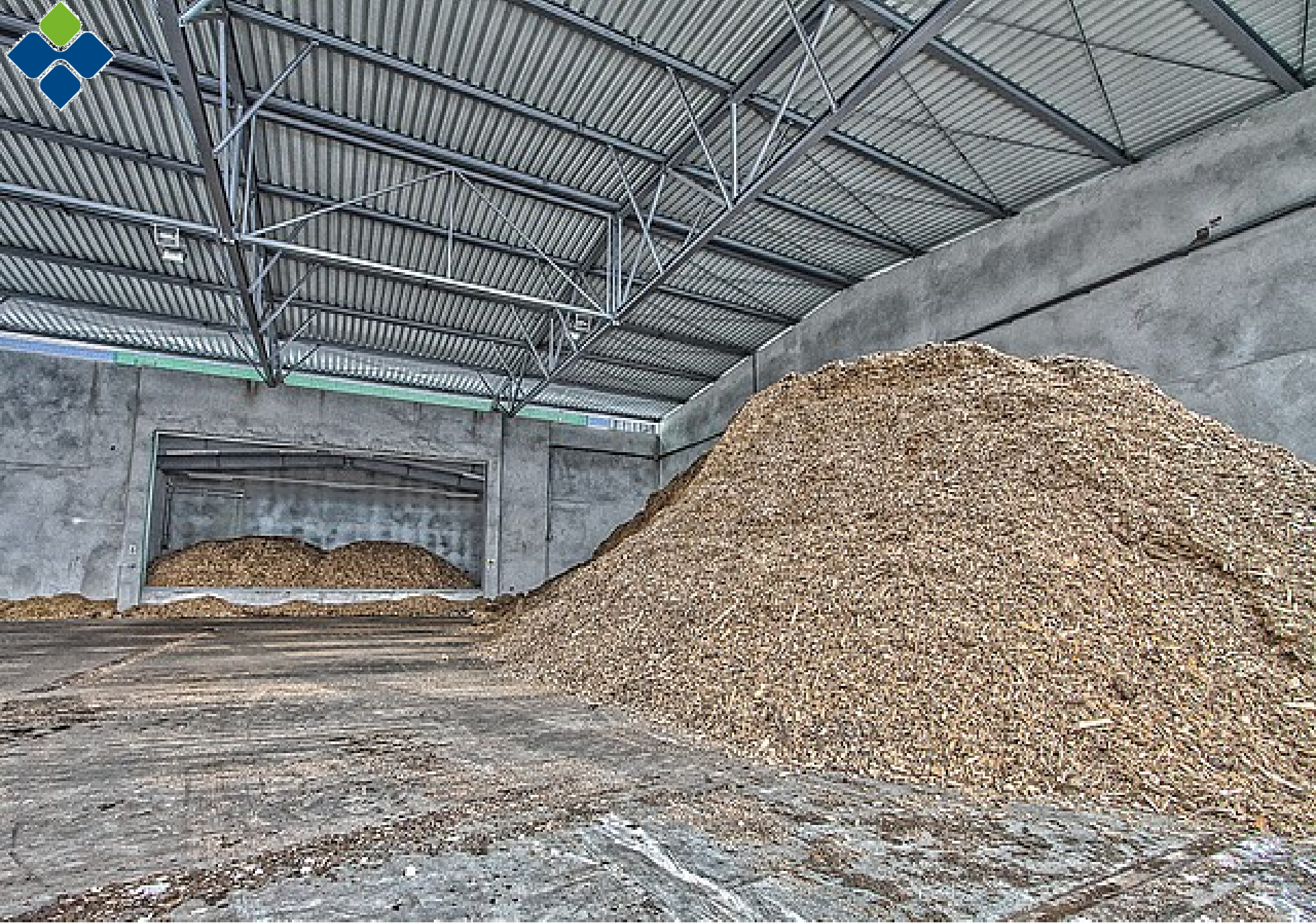
Wiata magazynowa biomasy. W głębi zasobnik dobowy z podajnikiem.
