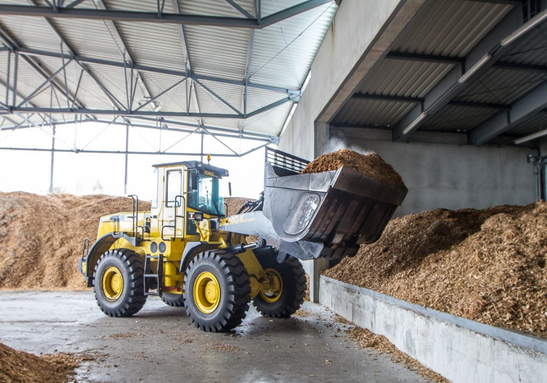
Załadunek biomasy do zasobnika dobowego z podajnikiem.
